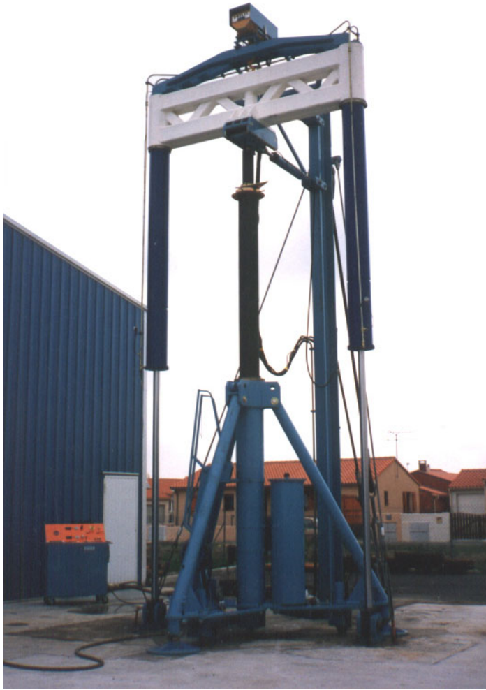
Tests of a hydraulic tripod (120 T nominal capacity) at 180 T in vertical and 18 in horizontal T simultaneously. Essais d'un tripode hydraulique (capacité nominale de 120 T) à 180 T en vertical et à 18 T en horizontal simultanément.
